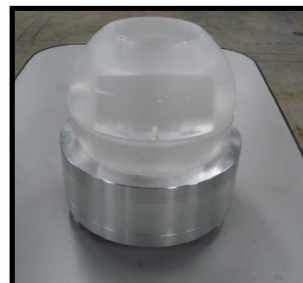
Fig. 1. Mancal aerostático formado pela esfera de acrílico e estator
