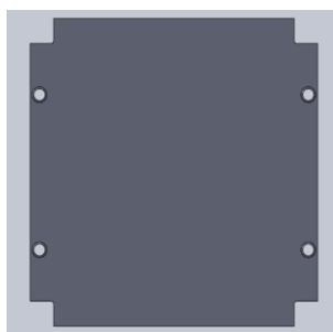
Figura 3 – Painel das extremidades superiores e inferiores do NANOSATC-BR2
