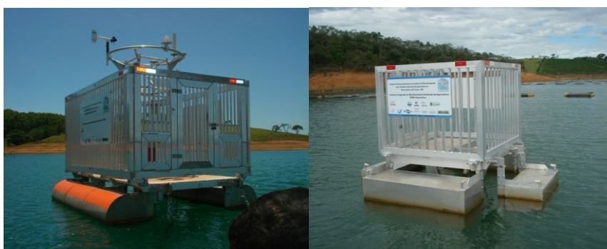
Figura 1. SIMA completo, com transmissão por satélite (esquerda), e SIMA Aquicultura, somente com registro a bordo (direita).
