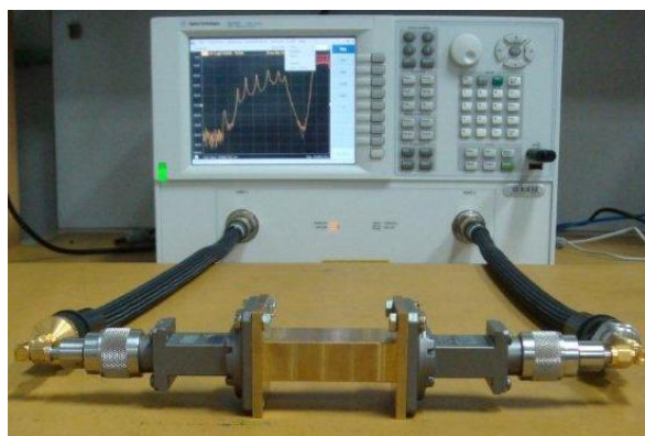
Figura 5. Montagem experimental completa conectada ao analisador de rede para medir o espectro de transmissão das redes de ressonadores de anéis concêntricos com seis células.
