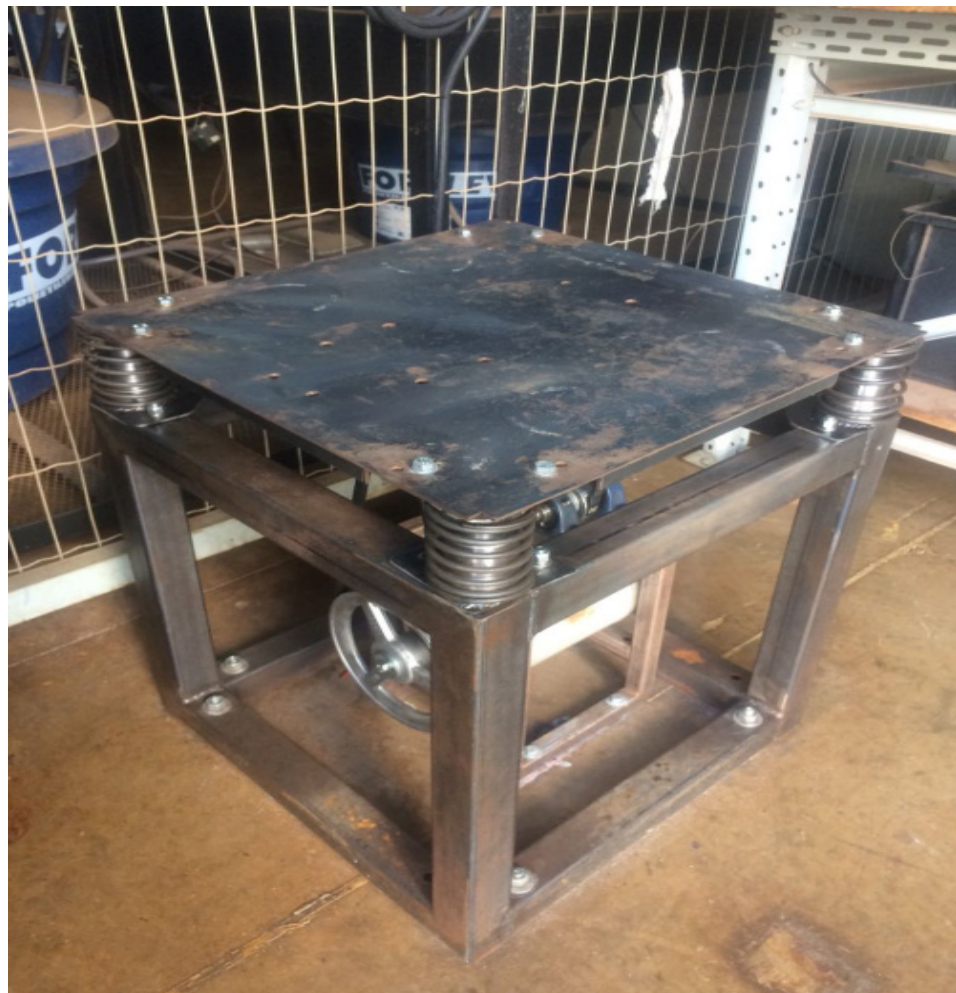
Figura 5. Bancada para ensaios vibratórios em componentes veiculares
