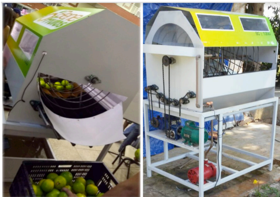
Figura 4. Beneficiadora de fuso rotativo.
