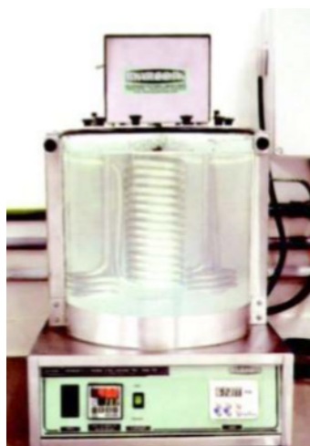
Figura 4 - Viscosímetro cinemático (Revista Cultivar Máquinas nº 5)
