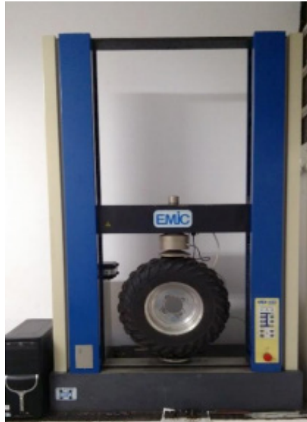
Figura 7 – Realização do teste de compressão
