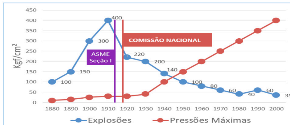
Figura 1: Gráfico do impacto da seção I do código ASME e da Fundação National Board.
