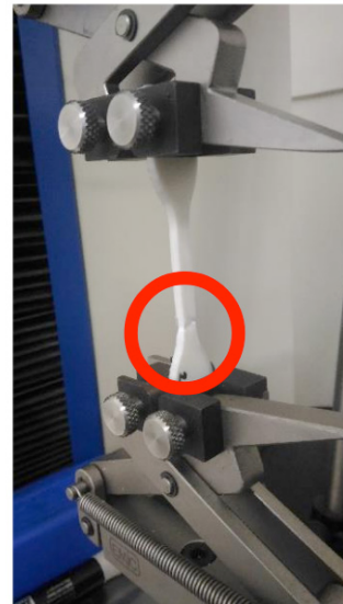
Figura 09: corpo de prova com detalhe no rompimento.
