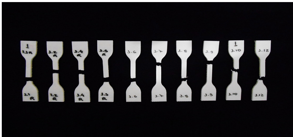
Figura 10: Corpos de prova do tipo 01 rompidos após ensaio de tração.
