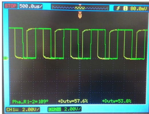
Figura 14 – Sinais dos canais A (amarelo) e B (verde) em quadratura do encoder óptico, tratados pela PCB da Figura 10. Tais sinais estão defasados entre si por um ângulo de 109^\circ devido ao deslocamento no sentido positivo (para à direita) da mesa de varredura.
