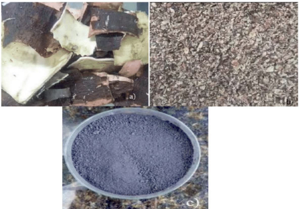
Figura 2 - a) Fibra da macaxeira após a exposição solar; b) Fibra da macaxeira seca e triturada e c) Carvão ativado da macaxeira.
