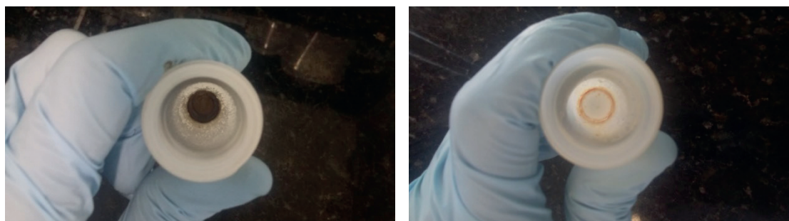
Figura 1 - Amostra de petróleo em tubo digestor antes e depois da etapa de digestão auxiliada por radiação micro-ondas.
