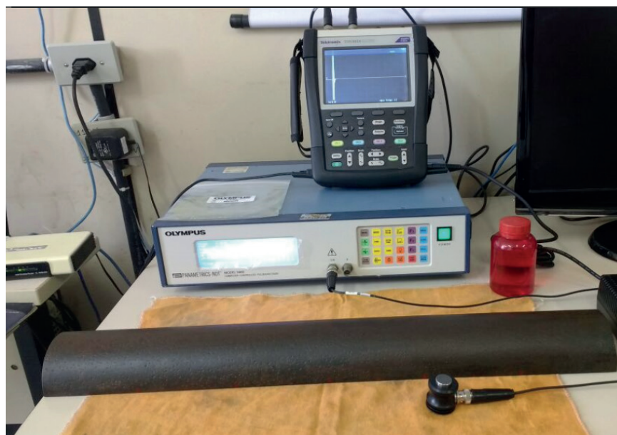
Figura 2. Configuração experimental do ensaio não destrutivo de ultrassom
