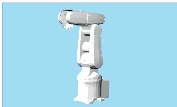
Figura 16: Simulação 3D do manipulador DENSO na posição home.
