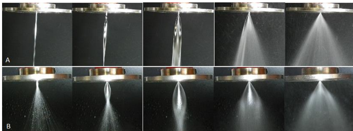
Figura 1. Efeitos da pressão de alimentação no filme líquido gerado pelos injetores centrífugos: a) etanol gelificado; b) água.
