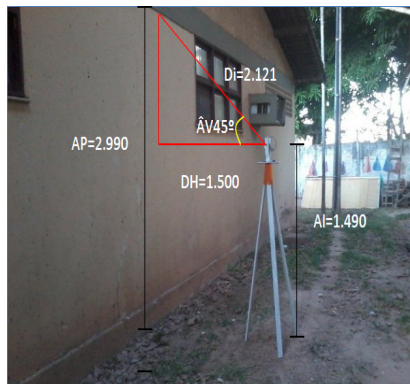
Figura 08: Medindo a altura da parede.
