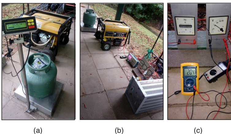
Figura 3 – Testes definitivos do gerador a gás com GLP – (a) gás sendo pesado – (b) gerador conectado a carga resistiva e (c) instrumentos de medição
