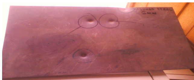
Figura 11: danos causados pelo projétil.
