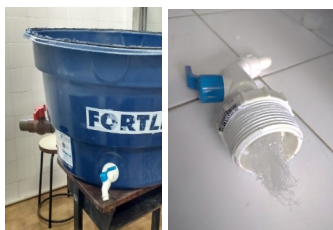
Figura 4 – Saídas para digestato (esquerda) e filtro de nylon na saída da fase líquida (direita).
