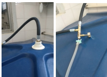
Figura 5 – Conexão do sistema de coleta do biogás à caixa d'água (esquerda) e saída adaptada para a coleta de gases antes de passar pelo filtro de carvão ativado (direita).
