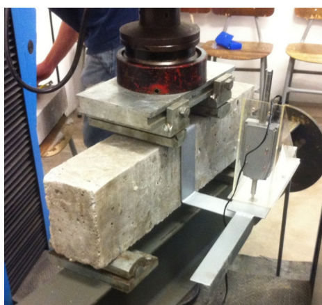
Figura 14 – Ensaio da viga vista dos fundos.
