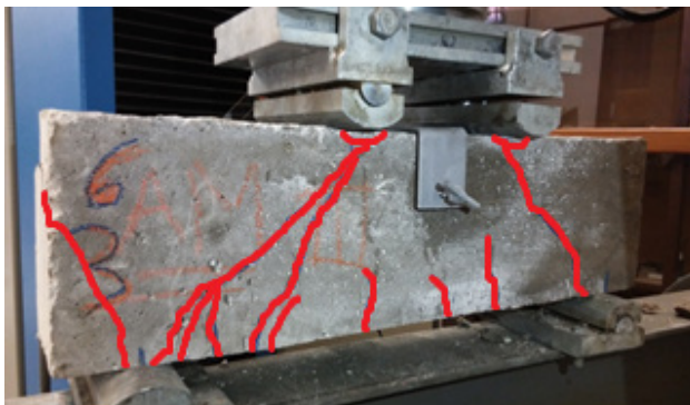
Figura 38 – V06–C fissuras após o ensaio.
