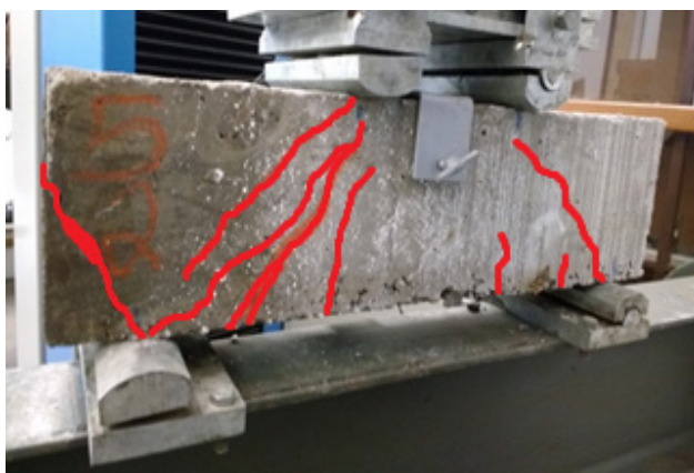
Figura 33 – V05-B fissuras após o ensaio.
