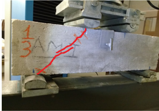
Figura 18 – V01–C fissuras após o ensaio.
