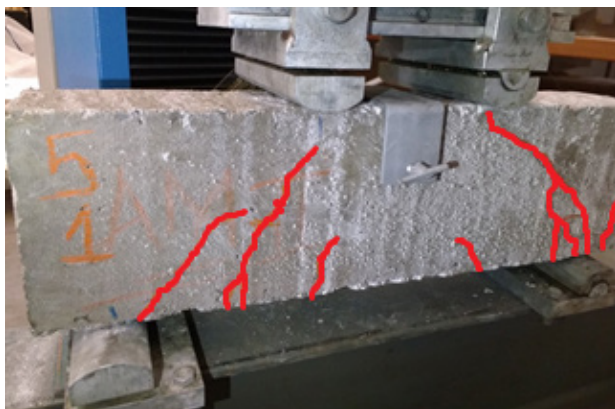
Figura 32 – V05-A fissuras após o ensaio.
