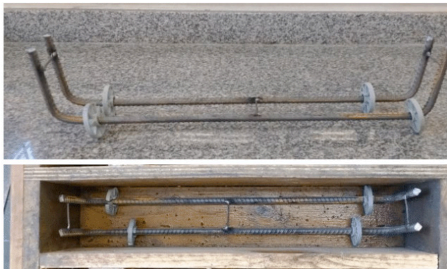
Figura 7 – Armadura V01 sem estribos, somente armadura principal 2 Ø 10,0 mm.
