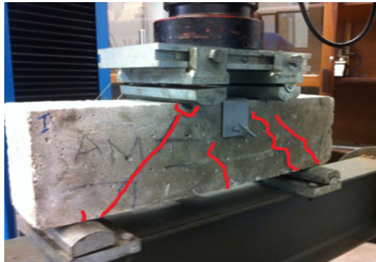
Figura 16 – V01-A fissuras após o ensaio.
