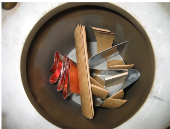
Figura 1 - Célula de envelhecimento contendo os materiais sólidos.
