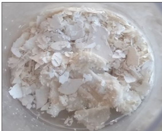
Figura 3. Imagem fotográfica das fibras de TiO 2 obtidas por electrospinning , após o tratamento térmico a 650 °C.
