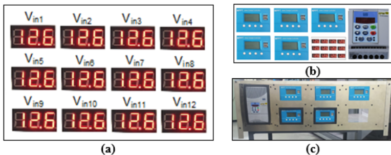
Figura 9 – Painel de Controle e Monitoração – (a) Disposição dos Displays – (b) Lay Out – (c) Parcialmente montado
