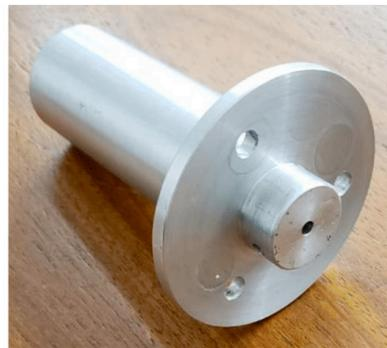
Figura 13: Cubo de Roda Fabricado.
